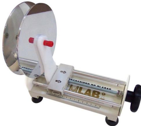
**Capacitor de placas, para visualização da relação entre carga, tensão e capacidade, determinação das constantes de campo dielétricas e elétricas.**
